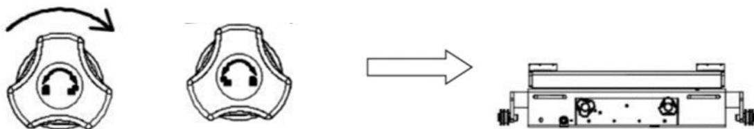
**Verrouillage** : Pour verrouiller la plate-forme et travailler en toute sécurité en libérant les composants hydrauliques, il suffit de tourner la poignée gauche dans le sens inverse des aiguilles d'une montre jusqu'à ce qu'elle s'appuie sur un cran de sécurité.
